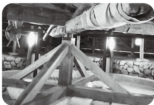
奈落に設置されている回り舞台装置
